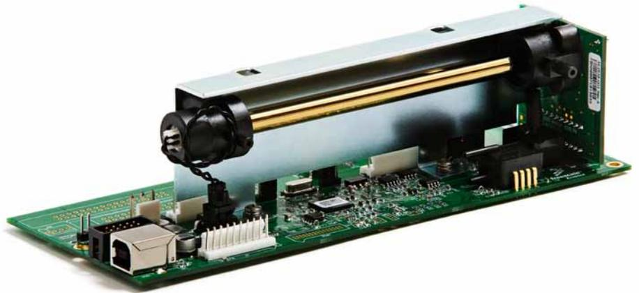
Andros 6500 系列通过简化设计和实施提供了无与伦比的性能和准确性。6500 系列采用脉冲红外光源，内部没有任何移动部件，因此能够在保证可靠性的同时获取更高的精度。
